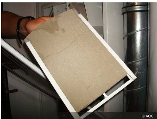
Filtre VMC DF encrassé - Source AQC
