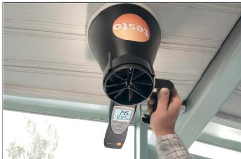
*Mesure du débit d'air avec un anémomètre et un cône de mesure, source Testo.*
