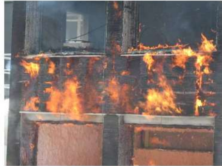
Détail allèges niveau N à t = 15 min
