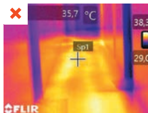
Bouclage d'eau chaude sanitaire noyé dans la dalle sans isolation. ©ENERGICO
