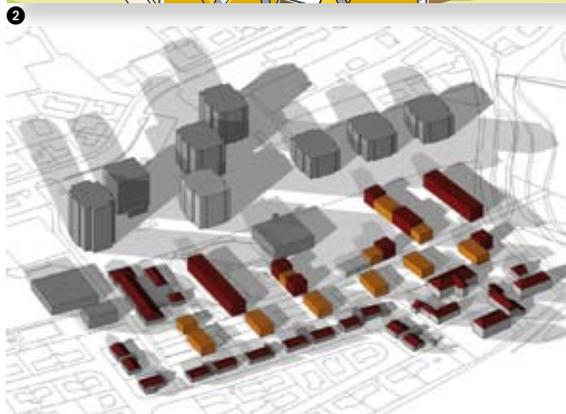
1 Agir sur l'orientation de la voirie, du parcellaire et du bâtiment en respectant les principes bioclimatiques. Dessin du plan de masse en fonction des courbes de niveau.
