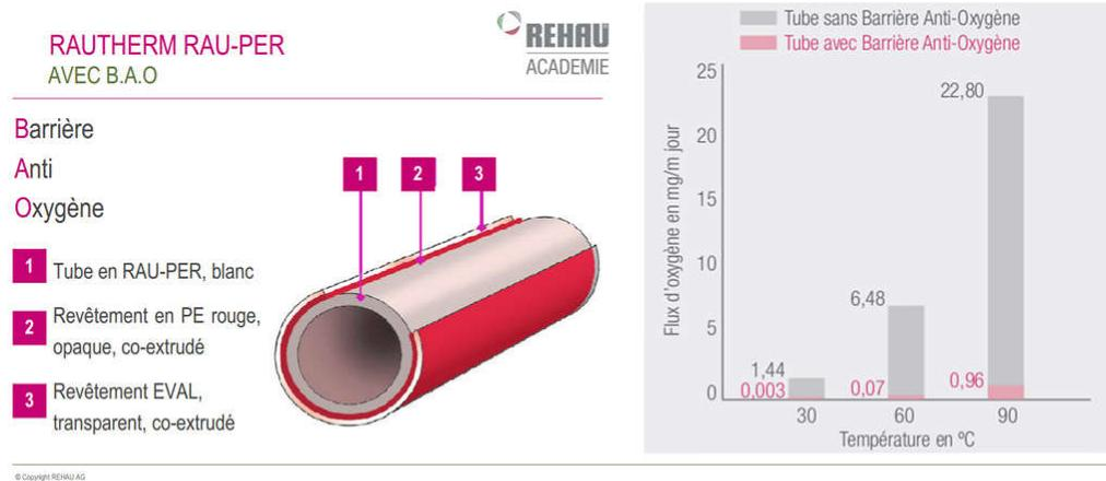
Malheureusement, le PER est **naturellement poreux à l'oxygène** et non imperméables au UV, entraînant un **apport continu en oxygène** à l'eau du chauffage, **favorisant le développement des algues et de la corrosion**, donc **l'embouage du circuit**
