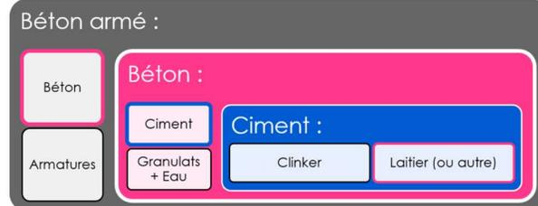
Le poids carbone du béton (hors armature) est très lié au poids carbone du ciment (clinker).
