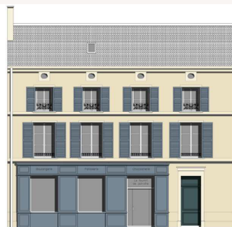
Schéma d'une devanture en applique, qui marque une saillie par rapport au nu du parement. Extraits de l'AVAP de Joinville (2016)
