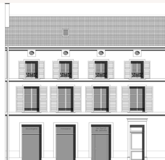
Schéma d'une devanture en fond de feuillure, faite en simple menuiserie en retrait par rapport au nu du parement.
