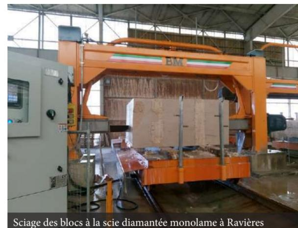
Sciage des blocs à la scie diamantée monolame à Ravières
