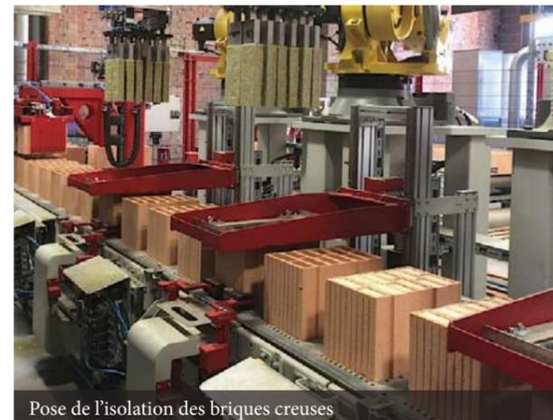
Pose de l'isolation des briques creuses
