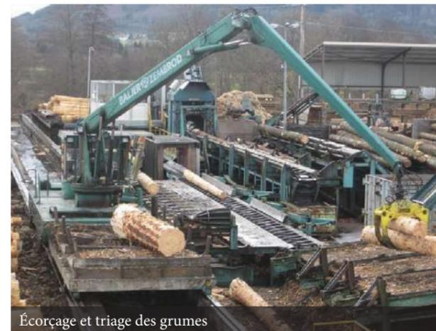
Écorçage et triage des grumes
