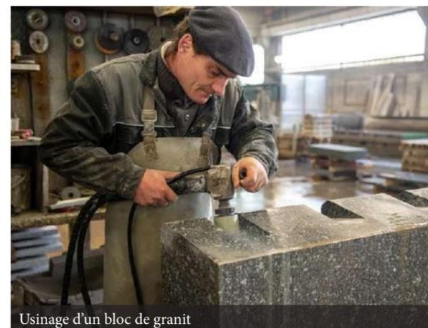
Usinage d'un bloc de granit
