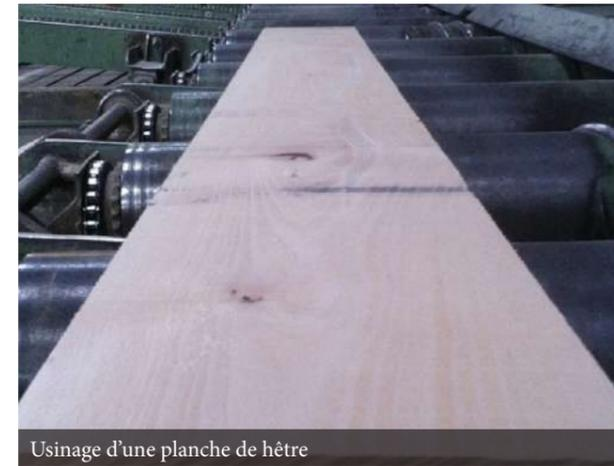
Usinage d'une planche de hêtre
