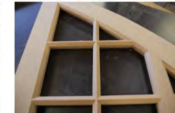
Menuiseries neuves à petits bois pour recevoir un double vitrage, 10 mm remplissage gaz krypton © Atelier G. André
