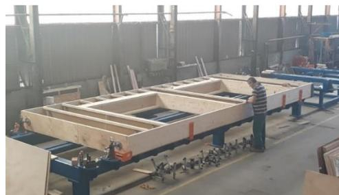
En plus des châssis, nous avons développé des cales de positionnement des poutres intérieures. Elles permettent de garantir la précision d'assemblage et de pouvoir travailler plus rapidement. Une fois les caissons préparés, ils sont ensuite présentés devant la machine de remplissage automatisée.
