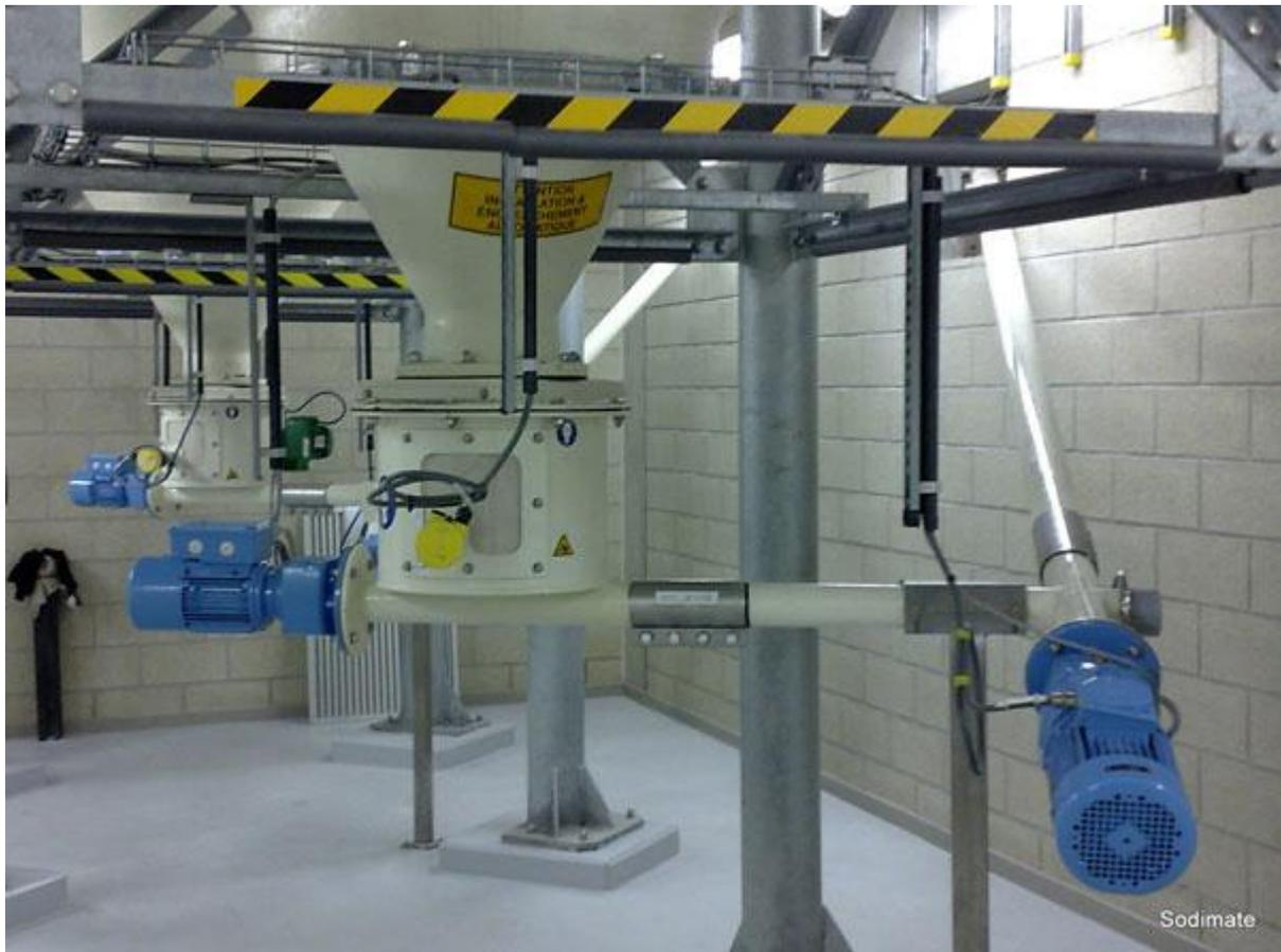
Une fois le lait de chaux préparé, il est associé au granulats végétaux afin de réaliser des mélanges aux dosages précis et réguliers. Ce mélange est ensuite acheminé vers un bac déverseur, venant remplir des pré-cadres ou ossatures.
