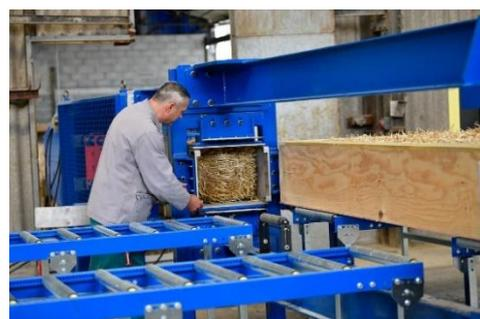
Le remplissage des ossatures avec les bottes de paille peut se faire jusqu'à des cadences de 30m<sup>2</sup> par heure de production avec une seule personne.
