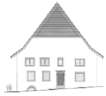
Une sur-toiture en latte de mélèze unifie la partie neuve et l'existant. Elle couvre les éléments techniques sortants et permet d'intégrer le grand volume du bâtiment public dans le village. Cette sur-toiture fait également office de brise soleil sur les verrières et de pare-neige sur la toiture à très forte pente.
