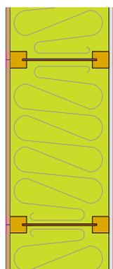
Vue en plan d'une paroi avec des caissons en «I» isolés en ouate de cellulose
