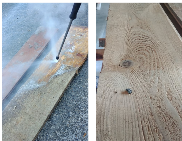
Ci-dessus le nettoyage d'une planche au jet haute pression pour retirer les résidus de colle sur la planche. Les planches ont également été triées, débarrassées des pointes, séchées, délignées suivant 3 largeurs et brossées
