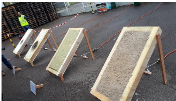
Essai comparatif (IDEM 2018), de 10 cm d'isolant sur plaque de plâtre. De gauche à droite : le PSE a brûlé au bout de quelques minutes, la laine de verre peu dense l'a suivi, alors qu'après 30 mn, la laine de roche dense et la ouate de carton tenaient encore !
