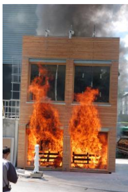
Essai au feu (CSTB 2009) pour paroi d'école en ossature bois isolée de paille
