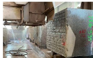
Gros débit - Sciage de tranches (verticale/horizontale)
