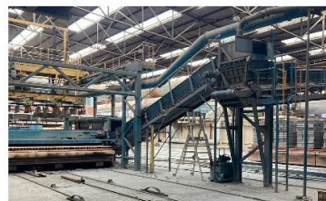
Tapis vers zone d'extrusion et de découpe
