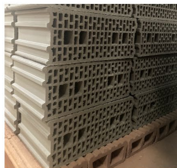
Briques terres crues séchées avant cuisson
