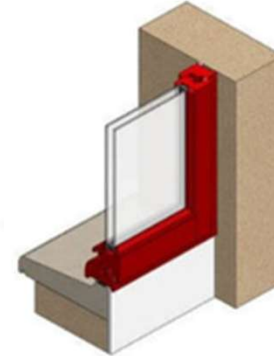
Pose en tunnel
