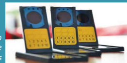
Détecteur radon exposé dans chaque pièce pendant 2 mois
